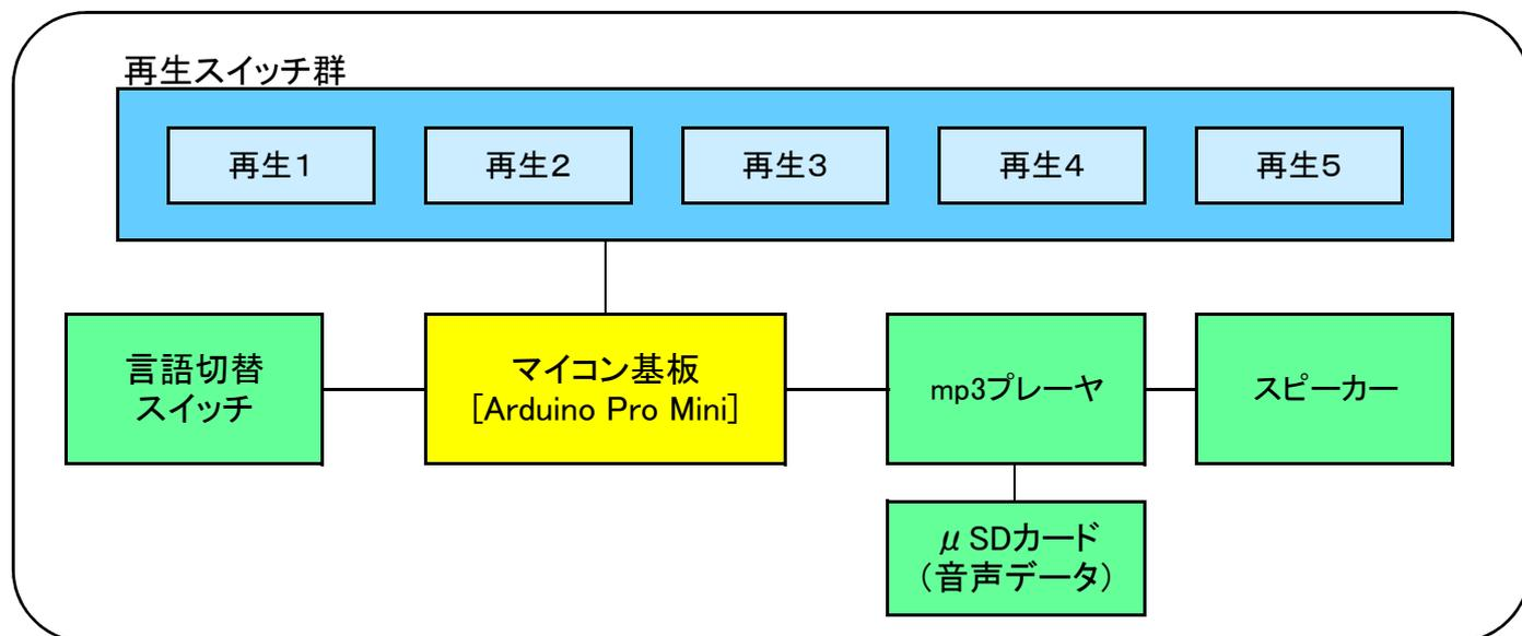
マイコンを用いれば複数の音声から選択して出力できます。
